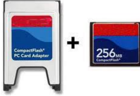
Resim 5.6: PCMCIA CF uyumlaştırıcı kartı ve compact flash hafıza kartı
