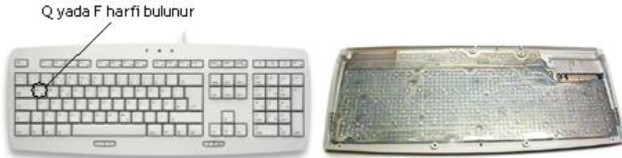
Resim 1.2: Klavyenin iç ve dış yapısı
