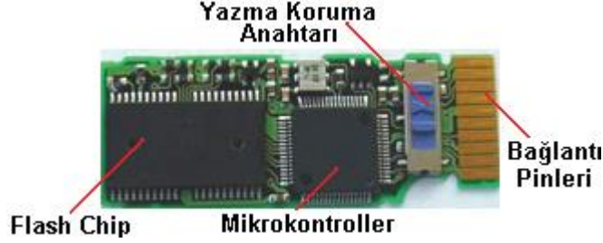
Resim 5.2: Hafıza kartı iç yapısı ve bileşenleri
