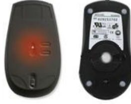
Resim 1.9: Optik ve mekanik farenin alttan görünüşü
