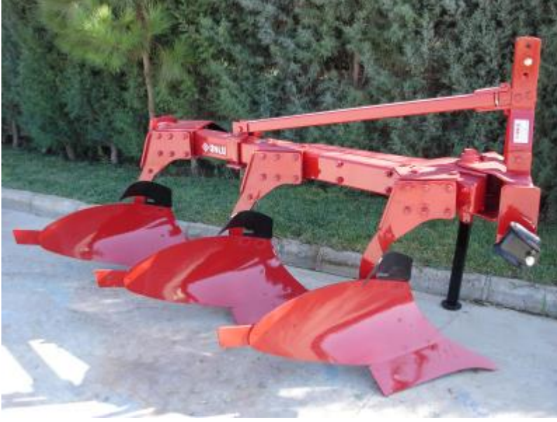
Şekil 2. Toprağı Devirerek İşleyen Soklu Pulluk
