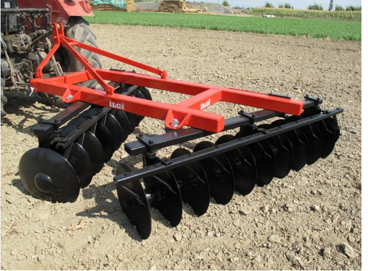
Şekil 3. Toprağı Karıştırarak İşleyen Diskaro
