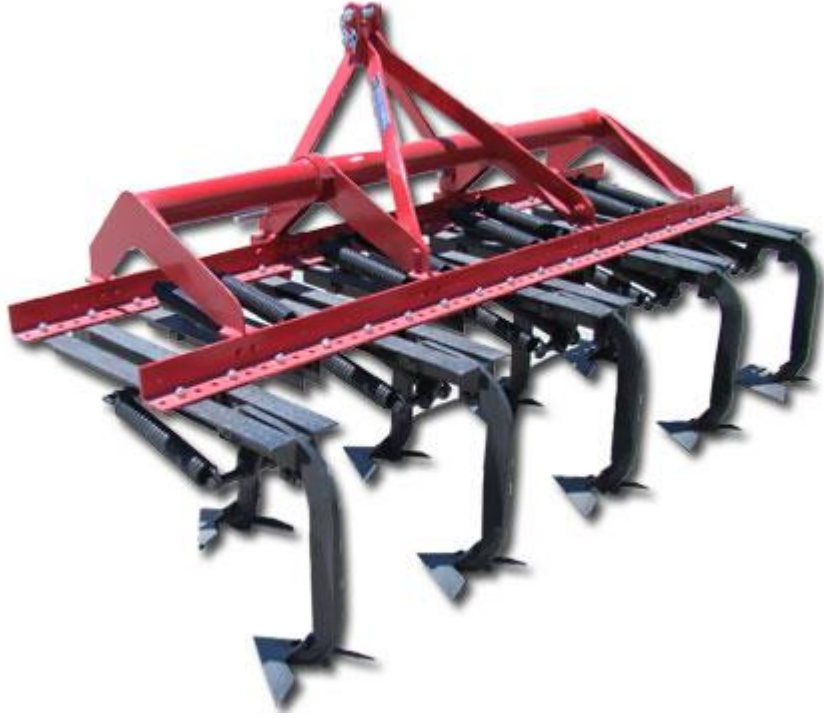
Şekil 4. Toprağı Alttan Yırtarak İşleyen Kazayağı
